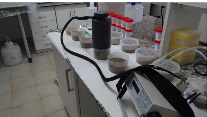
Figura 1. Cilindros de acoplamiento y equipamiento empleado en los ensayos de respiración celular. Se observa el brazo sensor de infrarrojo que es quién a la postre realiza la medida.
