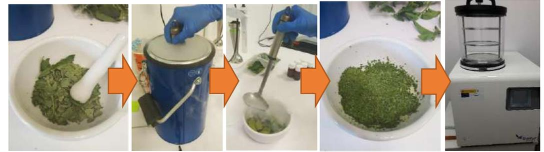
**Figura 1.** Esquema de preparación de las muestras de hojas; la última imagen corresponde a un liofilizador utilizado para eliminar el agua de las muestras (LyoQuest, Telstar, España).
